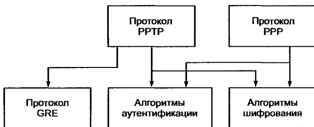
Рис. 11.2. Архитектура протокола PPTP
