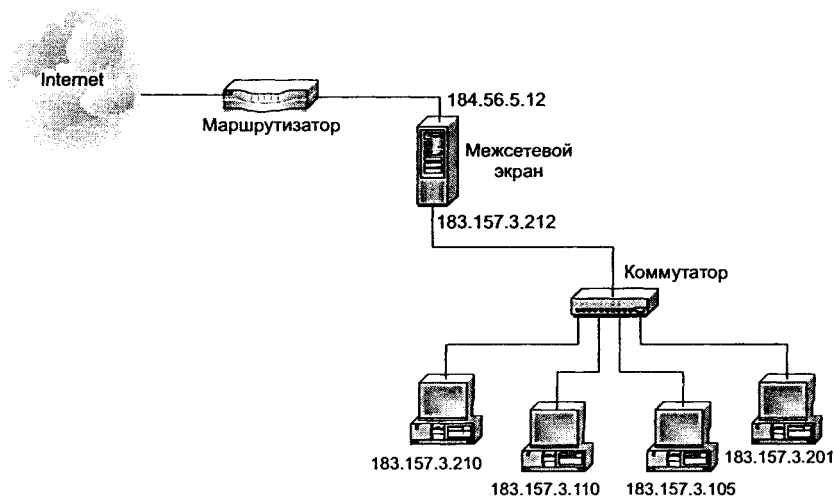
Рис. 9.4. Трансляция сетевых адресов
