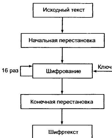
Рис. 6.2. Обобщенная схема шифрования в алгоритме DES
